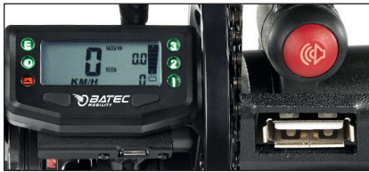
Pantalla LCD todo-en-uno con ciclocomputadora. Bocina y USB.
