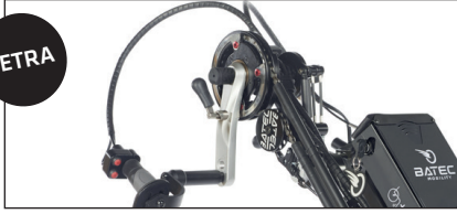
TETRA Bielas de aluminio de 170/150 mm. Modo E combinado con el BATEC MAGIC LEVER.
