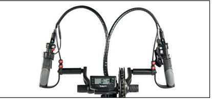
Nueva electrónica propia con 3 niveles de asistencia + modo E. Sensor de freno con corte de corriente.
