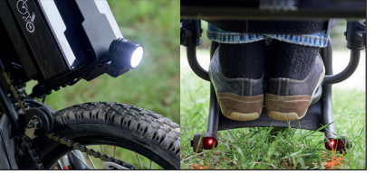
Luz delantera de 700 lúmenes. Doble luz trasera LED en el caballete.
