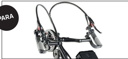
PARA Bielas de aluminio de 150 mm. Nuevo acelerador de gatillo.
