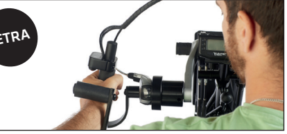
TETRA BATEC SHIFT LEVER: Cambio de marchas Shimano REVO 8.
