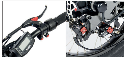
Disco de 200/203mm, dos frenos mecánicos, dos manetas de aluminio con freno de estacionamiento.
